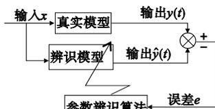
图1 模型参数辨识原理
