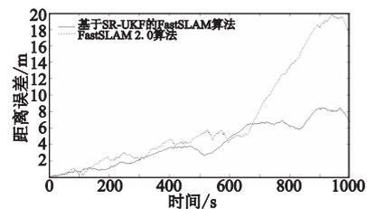
图4 FastSLAM 2.0与基于SR-UKF的FastSLAM算法距离误差比较
