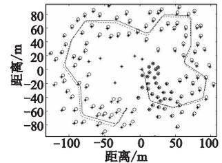
图3 基于SR-UKF FastSLAM 2.0仿真环境中的路径和地图估计
