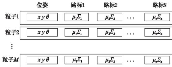
图1 FastSLAM中粒子的数据结构
