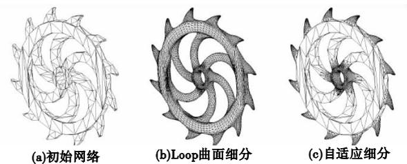
图 5 齿轮自适应细分效果
