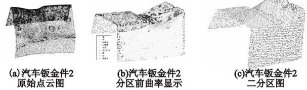
图3 汽车钣金件2点云数据区域分割
