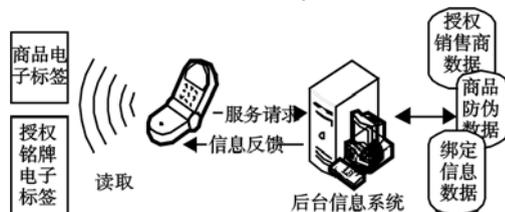
图2 移动RFID监控系统结构
